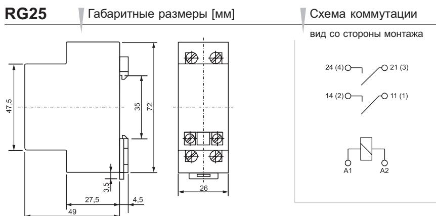
Реле **RG25** предназначены под монтаж на рейке DIN 35 мм EN 50022. Рабочее положение - зажимы выводов катушки внизу.
