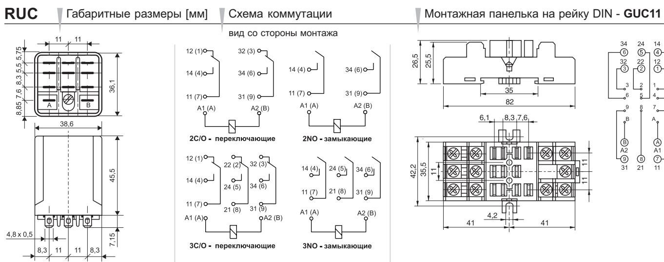
Реле **RUC** монтируются в: • контактные колодки с винтовыми зажимами **GUC11** со скобой **MBA**, монтаж на рейке DIN 35 мм EN 50022 или на поверхности • клеммное подсоединение с применением клемм тип AMP - FASTON 187 (4,8 x 0,5 мм) • непосредственной впайкой в печатную плату.
