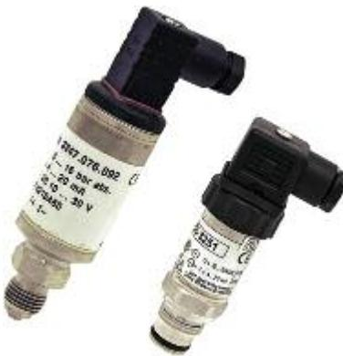
Разработаны для тяжелых условий эксплуатации. Данная серия отличается широким рядом диапазонов измерения, высоким классом точности, измерением как абсолютного, так и относительного давления. Для работы с вязкими, загрязненными, агрессивными средами применяются датчики с внешней мембраной (SEN-3251/52...).
