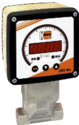
Предназначены для измерения и контроля потока жидкости и газов. Принцип работы основан на измерении разности давлений до и после сужающего устройства в корпусе расходомера. Разность давлений прямо пропорциональна значению расхода.
