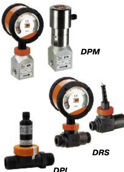
Недорогие компактные расходомеры для измерения потока жидкостей, работающие по принципу рабочего колеса турбины. Вращение колеса турбины бесконтактно передается с помощью встроенных в лопатки магнитов на преобразователь сигналов. Скорость вращения прямо пропорциональна значению расхода.
