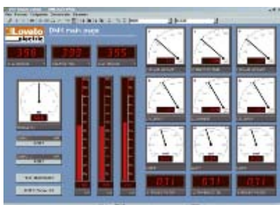
Окно программы дистанционного контроля мультиметра на персональном компьютере
