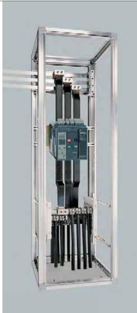
Система центрального ввода питания до 4000 А объединяет ряд преимуществ: высокая устойчивость к токам короткого замыкания, монтаж без сверления отверстий, клеммная техника с двусторонним обхватом и понятная конструкция (стр. 3/1 и 3/2)
